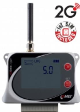
El datalogger GSM está diseñado para registrar 3 entradas de voltaje y una entrada de dos estados. En el caso de que los límites preestablecidos se excedan, se envían mensajes SMS y JSON vía conexión GPRS. Los valores medidos se pueden enviar al almacenamiento de Internet COMET Cloud, que es un sistema completo de monitoreo, alarma y análisis.
